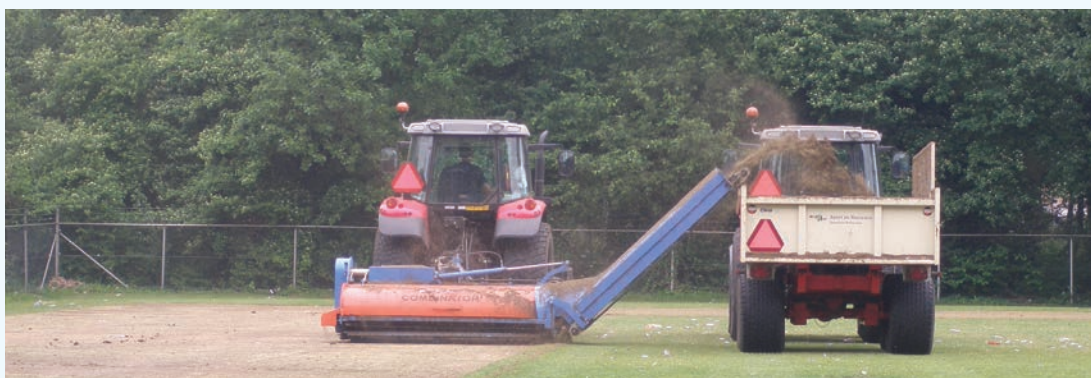
Figuur 6 Oppervlakkig maaifrezen
